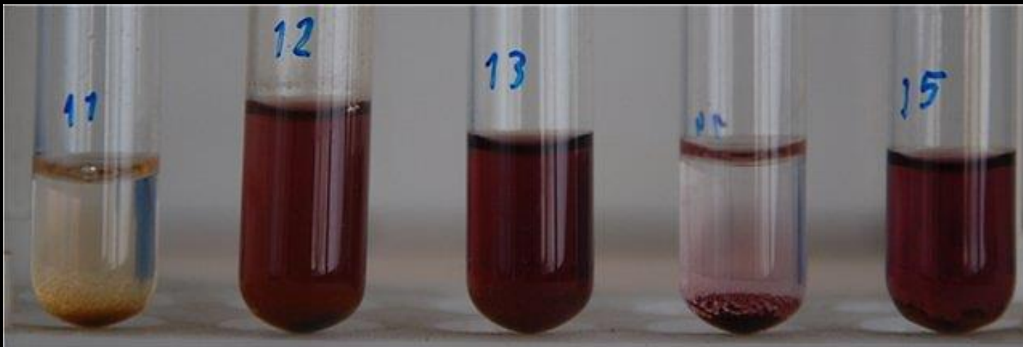
Растворы ферратов щелочных металлов
